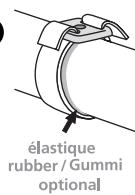
**Montage mit Edelstahlband** Bandlänge je nach Rohrdurchmesser wählen **1**. Ein Ende von unten durch das Spannstück führen und umbiegen **2+3**. Metallband um das Rohr legen, durch den zweiten Schlitz im Spannstück führen, leicht straff ziehen und umbiegen.
